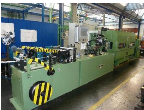
UNIWEMA® 60 TIG многодуговая сварка алюминиевой трубки
